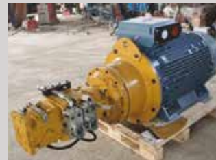
Motor Pompa Coupling Bağlantısı
